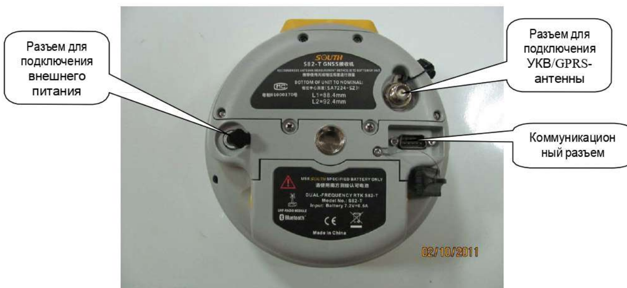
Рисунок 2.3 – Порты связи основного блока S82T
